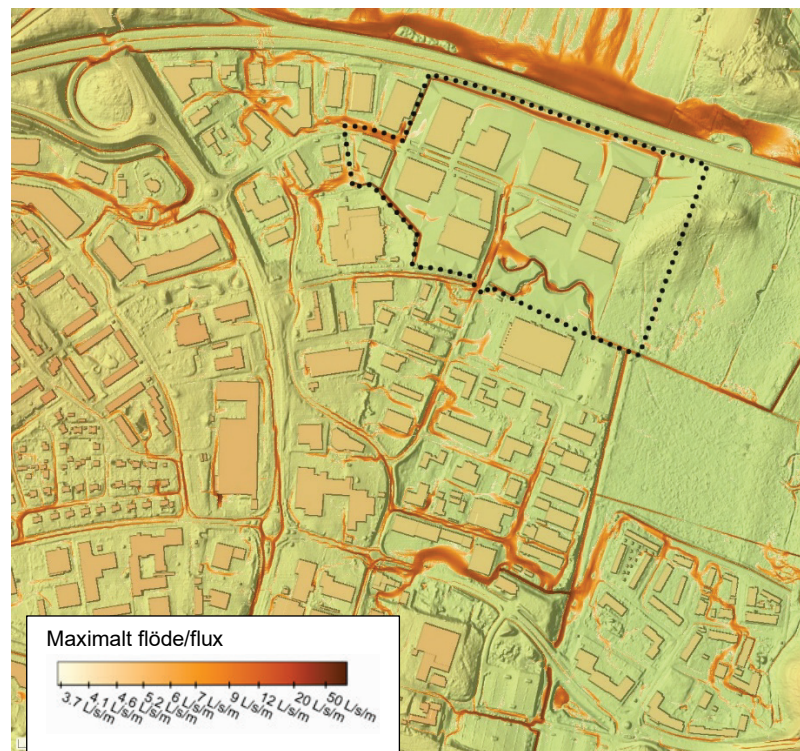
Figur 14 (t.h.). Maxflöde/-flux efter exploatering (Scalco Dynamic Flood, 2026). Flöden under 10 l/s,m visas inte.
