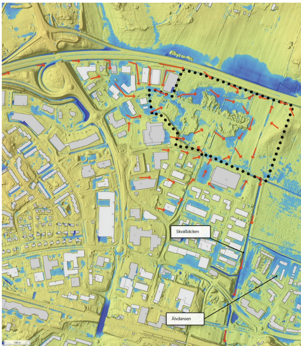
Figur 3. Befintliga lågpunkter och flödesvägar (Scalgo, 2026).
