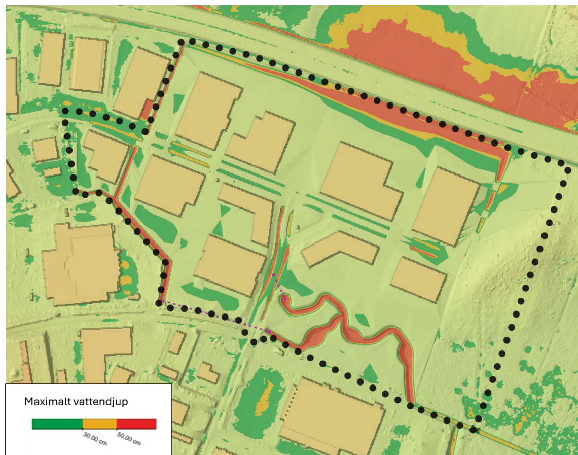
Figur 11. Maximalt vattendjup efter exploatering vid ett 100-årsregn, inklusive skyfallsdike i nordväst och lägre bräddnivå från västra Malmagatan mot sydvästra skyfallsdiket. Vattendjup under 10 cm visas inte.
