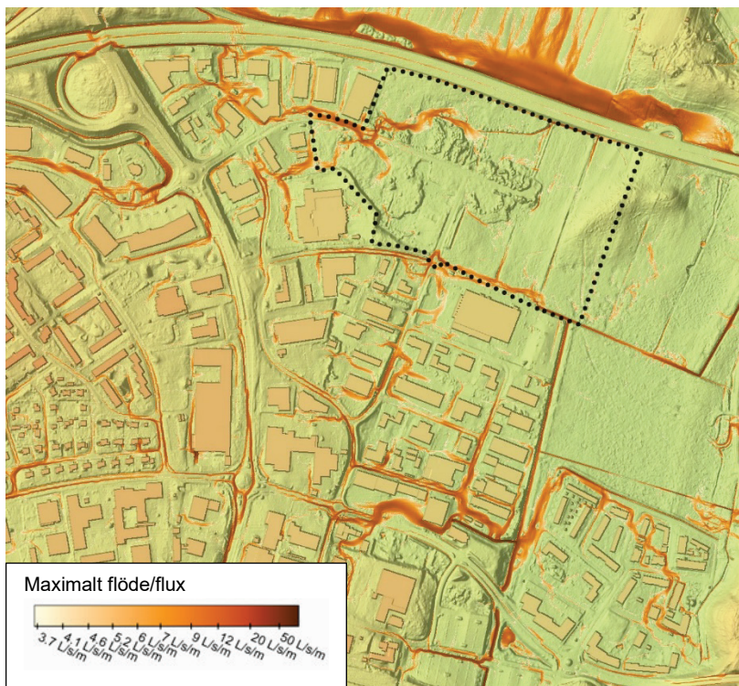
Figur 13 (t.v.). Maxflöde/-flux före exploatering (Scalco Dynamic Flood, 2026). Flöden under 10 l/s,m visas inte.
