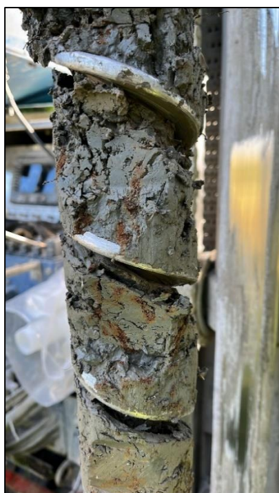
Figur 5. Rostutfällningar i leran vid provpunkt 25RE05 vid djup 0,3-0,5 meter.
