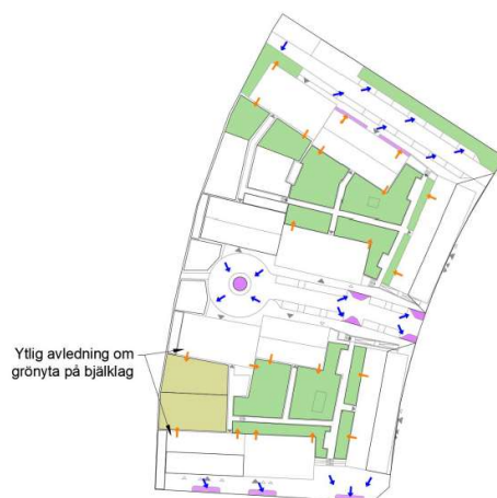
Figur 26. Ytlig avrinning från hårdgjorda markytor (blå pilar) samt takytor (orange pilar). Utsnitt ur Dagvattenutredning, Starkstad Project Partners AB, rapport 2024-10-21.
