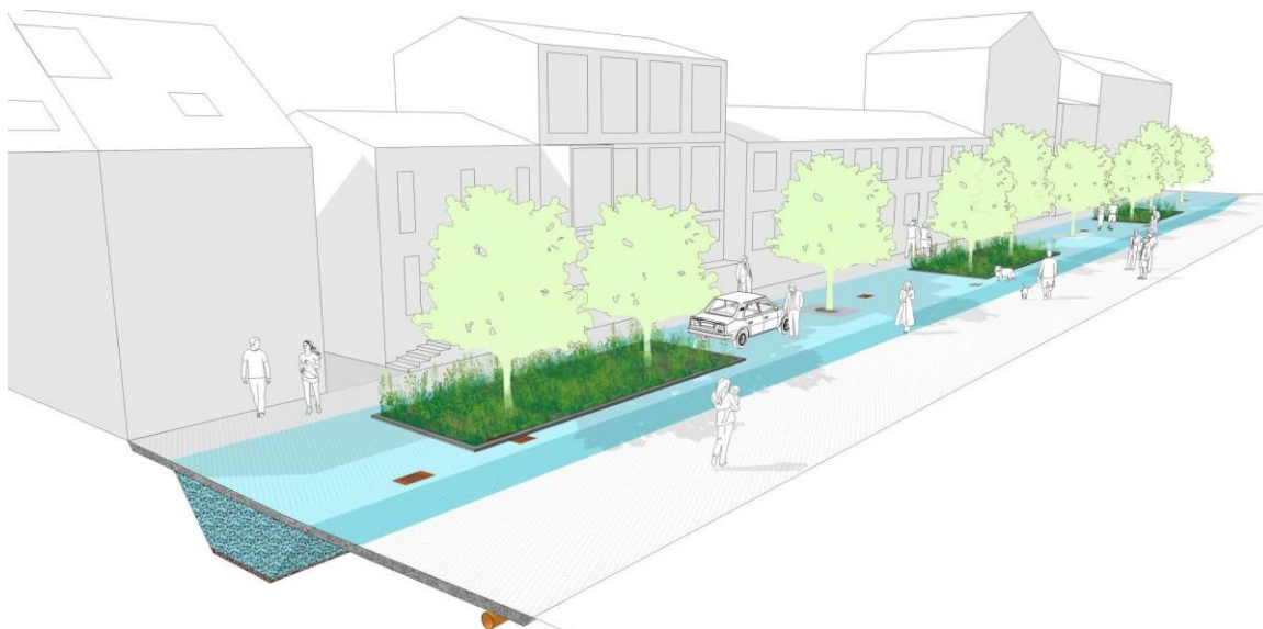
Figur 23. Schematisk skiss över ett öppet förstärkningslager under en gata, med regnbäddar och träd i anslutning. Illustration: Edge (Fridell m.fl., 2023).
