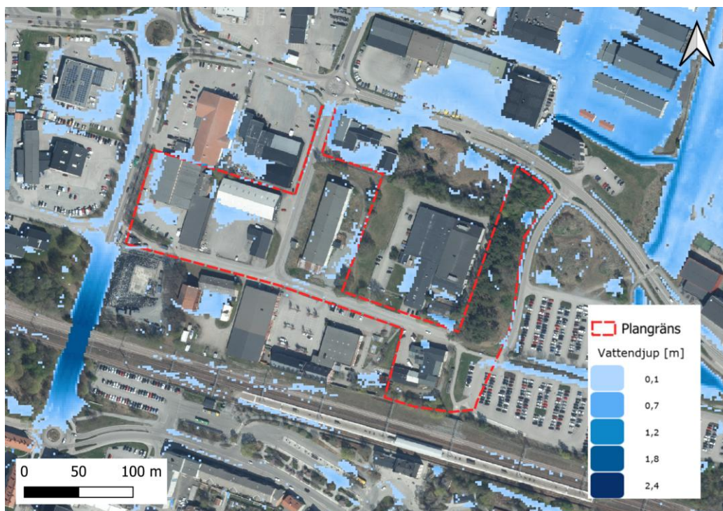
Figur 12. Översiktsbild över vattenansamlingar (blått) vid ett 100-årsregn enligt DHIs skyfallsmodell gjord i MIKE+ med klimatfaktor 1,3. Endast vattendjup större än 10 cm visas. Bakgrundskarta: (Lantmäteriet, 2024).
