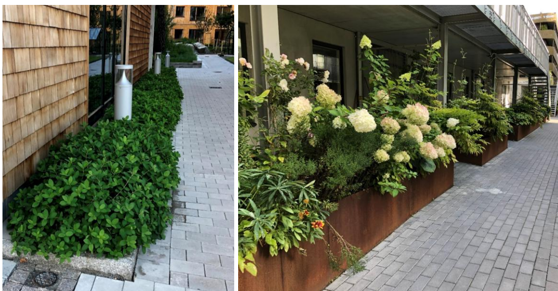
Figur 16. T.v: Regnbädd intill husfasad i Uppsala. T.h: Upphöjd regnbädd intill husfasad i Norra Djurgårdsstaden. Foto: WRS
