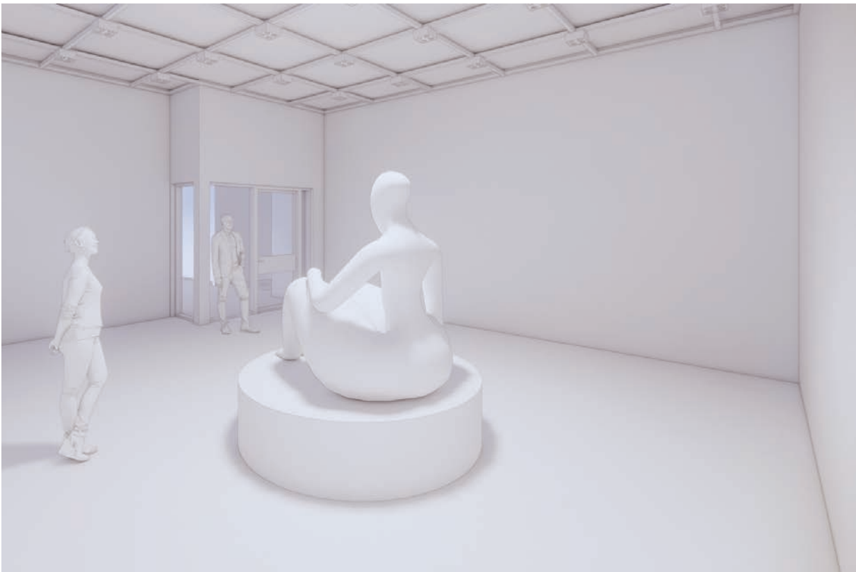
Konsthall. Rummet är fönsterlöst för att man ska kunna kontrollera ljuset . Glasparti mot foajé ska kunna mörkläggas.
